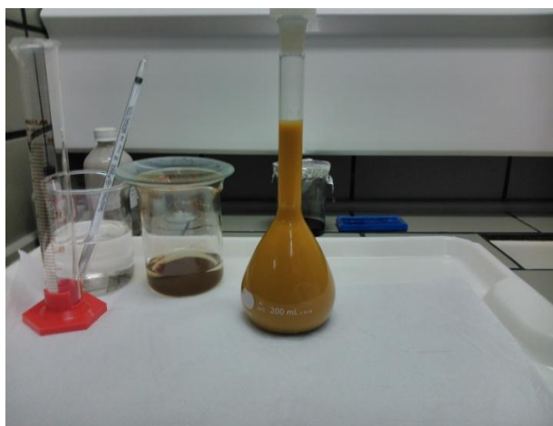
Figura 4: Óxido de grafite após a adição de 6 mL de H_2O_2 .
