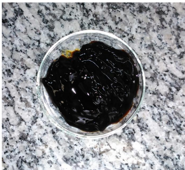
Figura 6: Óxido de grafite após as etapas de lavagem e centrifugação.
