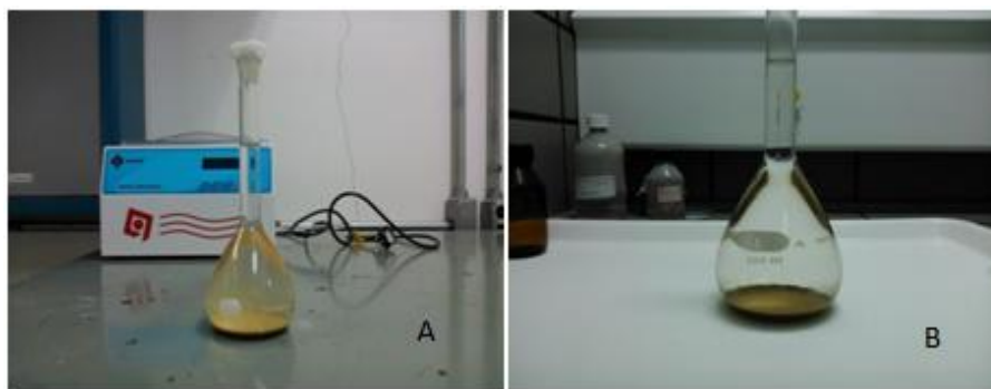
Figura 5: Processo de decantação do óxido de grafite após (a) 24h e (b) 48 h em repouso.
